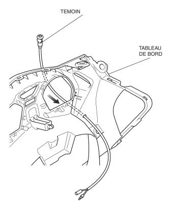
26. Installez temporairement le tableau de bord dans l'ordre inverse de sa dépose.
