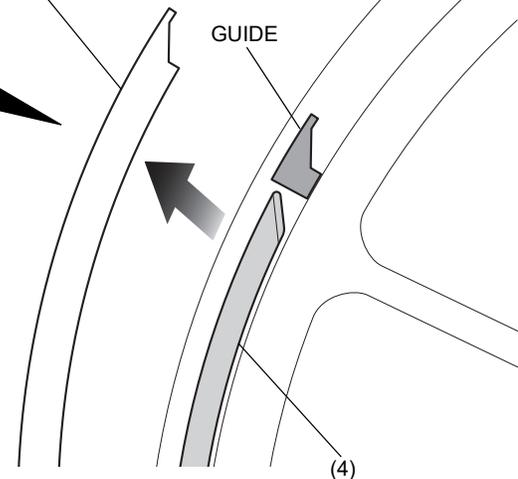
5. Retirez partiellement la partie adhésive détachable derrière la deuxième bande de roue avant gauche.
