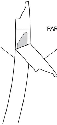
6. Appliquez la deuxième bande de roue avant gauche en guidant le bord du film d'application le long de la partie intérieure du contour de la jante, dans le sens contraire des aiguilles d'une montre.
