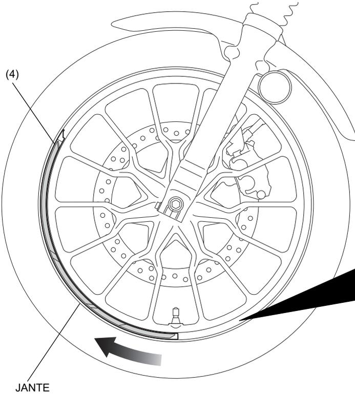
Alignez le bord de la bande de roue avant gauche sur le centre de la valve, comme illustré.
