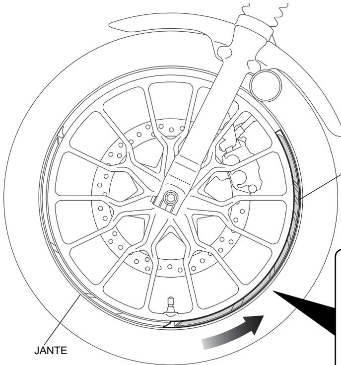
Alignez l'extrémité de la deuxième bande de roue avant gauche sur l'extrémité de la première bande de roue avant gauche (en alignant les bords).
