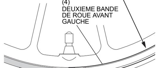
7. Appuyez fermement sur la deuxième bande de roue gauche pour la coller, puis décollez le film d'application et le guide.
