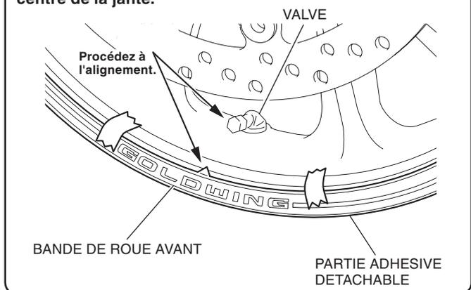
3. Retirez partiellement la partie adhésive détachable derrière la bande de roue avant, comme illustré.
