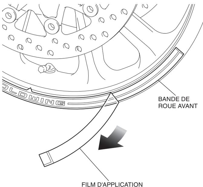
7. Installez provisoirement la deuxième et la troisième bande de roue avant de la même manière que pour la première bande de roue avant.
