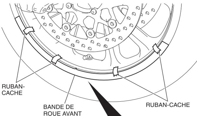
Installez provisoirement la bande de roue avant avec le centre de la jante.
