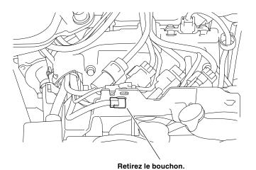
10. Installez le faisceau de câblage secondaire sur le connecteur rouge à 4 broches et fixez-le au support. Fixez le faisceau secondaire à l'aide de l'attachecâbles fourni, comme indiqué.
