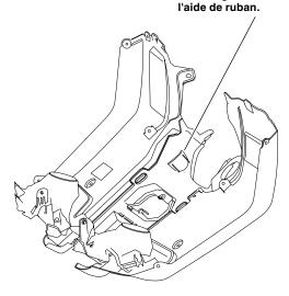
7. Percez un trou large à l'aide d'une scie-cloche de 1 5/16 pouce (33 mm) à l'endroit indiqué par une marque.
