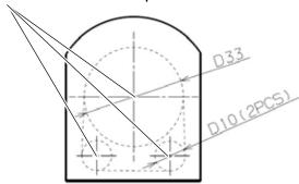
8. Après avoir percé les trous, utilisez un outil rotatif et une fraise au carbure pour lier les cercles en entaillant la ligne pointillée pour créer une ouverture.
