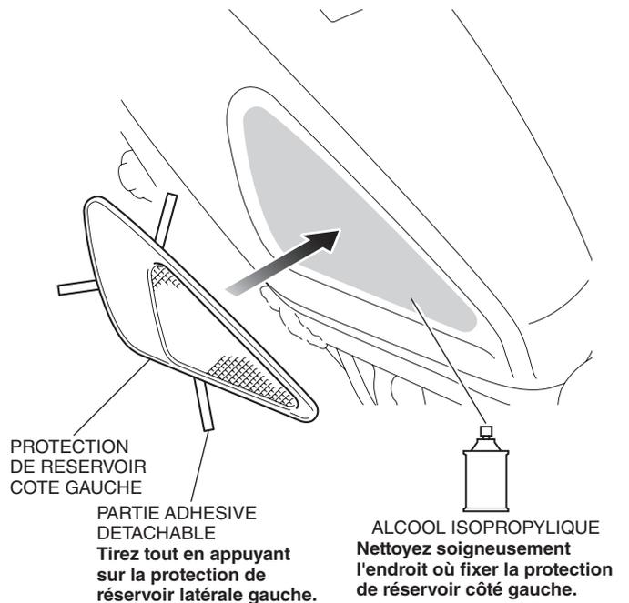
Fixez la protection de réservoir côté gauche en respectant les dimensions illustrées.
