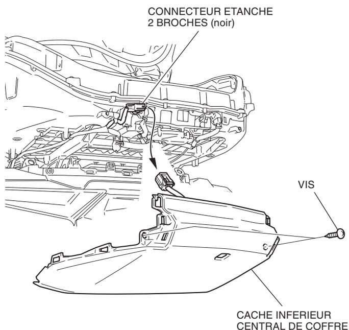
18. Débranchez le faisceau de l'élément de verrouillage du coffre comme indiqué.
