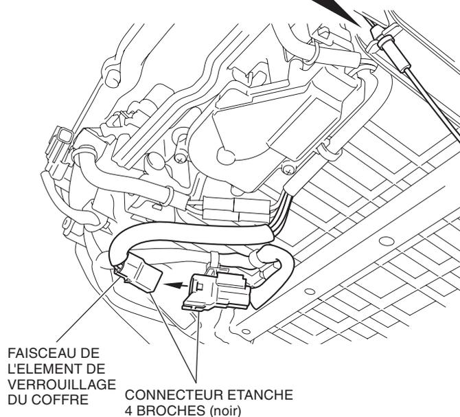
19. Déposez l'élément de verrouillage du coffre de la manière indiquée.
