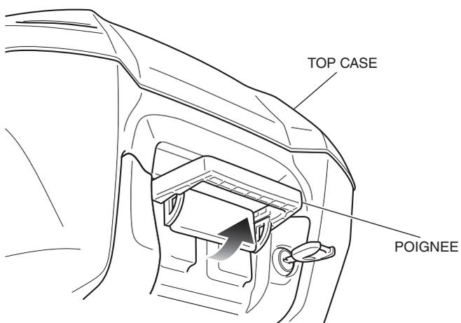
4. Insérez la languette de fixation du top case dans le trou du porte-bagages arrière comme illustré.
