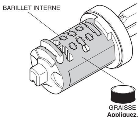
20. Montez le barillet interne en faisant glisser le contrepoids de butée le long du guide d'insertion tout en le faisant tourner.
